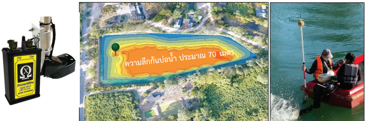
การวัดความลึกของบ่อน้ำโดยใช้เครื่องหยั่งความลึกของน้ำ (Echo Sounder)
