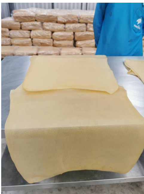
ภาพที่ ข.1 การเตรียมแผ่นห่อยางแผ่นอบแห้งเกรดพรีเมียม
