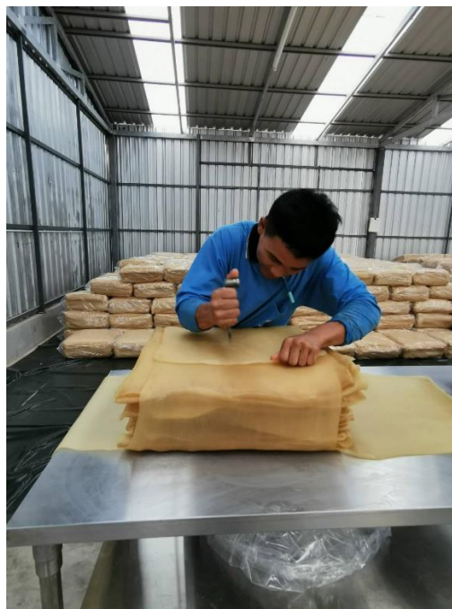
ภาพที่ ข.3 การดึงปลายแผ่นห่อเพื่อหุ้มยางแผ่นอบแห้งเกรดพรีเมียม
