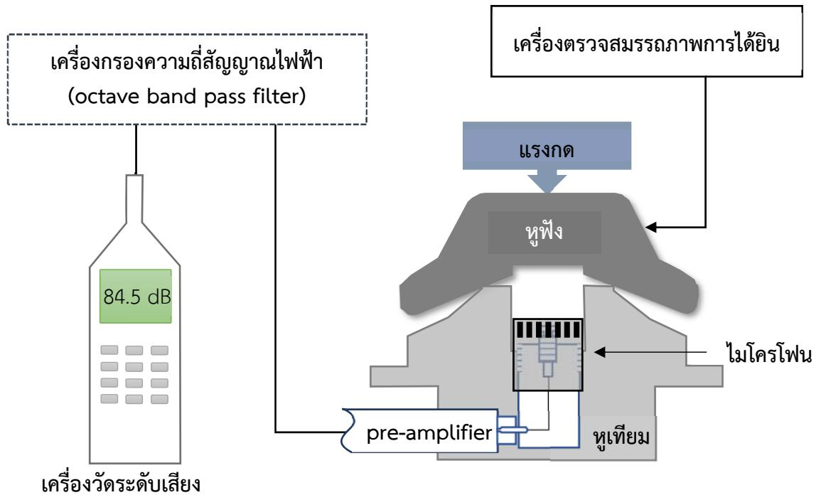
รูปที่ 3 การต่ออุปกรณ์สำหรับการวัดระดับความดันเสียงและการควบคุมระดับสัญญาณ
