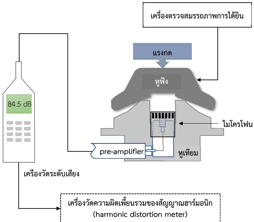
รูปที่ 5 แสดงการต่ออุปกรณ์สำหรับการวัดค่าความผิดเพี้ยนรวมของสัญญาณอาร์มอนิก
