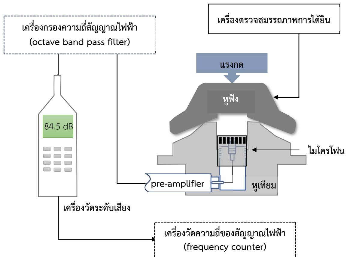
รูปที่ 2 แสดงการต่ออุปกรณ์สำหรับการวัดความถี่
